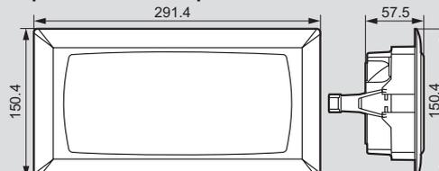
Скрытый монтаж с рамкой Кат. № 6 617 20 в вырезе в сухой перегородке
